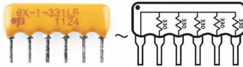
Uma matriz de cinco resistores de 330Ω, todos unidos em uma extremidade.
